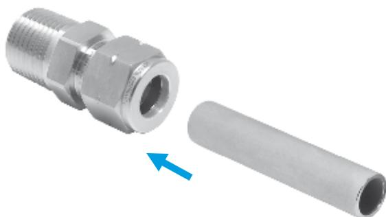
1. Vorbereitetes Rohr in die Hy-Lok Rohrverschraubungen einschieben, bis das Rohrende fest am Ansatz des Verschraubungskörpers anliegt. Danach die Mutter handfest anziehen.
