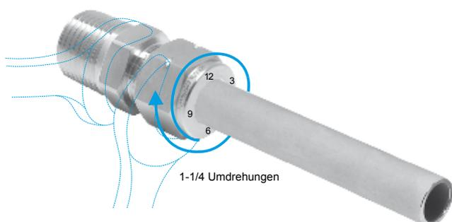
2. Mutter an der 6-Uhr-Position für die Kennzeichnung des Anfangspunktes markieren.
