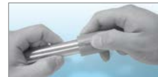
2. Nach dem Einsetzen des Rohres den Markerhebel drücken und den Rohrmarker drehen.
